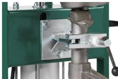
Dass die Lippen an beiden Federhalterungen gut greifen, wird dadurch sichergestellt, dass man unter besonders langsamem Druck nach unten die Schwenkkarre nach aussen zieht. Kann man die Federhalterungen herausziehen, greifen die Lippen nicht ordentlich !!
