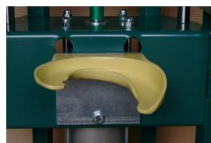
När en fjäder skall pressas ihop bör man med hjälp av ovanstående kontrollera att man har valt rätt tillbehör. När man monterar fjäderbenet längst ner måste man således säkerställa att fjädern har en större diameter än de innersta läpparna på den fjäderhållare som man har valt. Härigenom säkerställer man att fjädern inte glider av under tryck.
