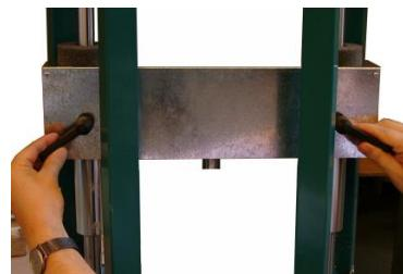
Hierdurch kann sich der Arm an den Federhalterungen nicht mehr seitlich bewegen. Nach abgeschlossenem Auswechseln der Stoßdämpfer darf die Fixierung an der Rückseite des Balanceauslegers erst gelöst werden, wenn der Druck von der Feder genommen wurde.
