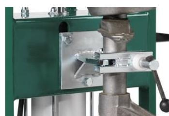
Губки обоих держателей пружины должны хорошо захватываться, что обеспечивает порядок, согласно которому при особенно «медленном» давлении вниз поворотные рычаги вытягиваются наружу. **Если держатели пружины можно вытянуть рукой, то это означает, что губки не захватывают надлежащим образом!!**
