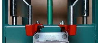
Det kan være nødvendigt, at montere andre fjederholdere end standard fjederholderne. Dette kan enten være fjederholdere med korte læber (se Fig. 6), som fortrinsvis anvendes til Toyota og Honda som er produceret i Japan. Andre special fjederholdere findes til forskellige bilmodeller.
