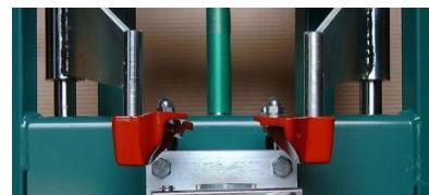
Det kan vara nödvändigt att montera andra fjäderhållare än standardfjäderhållarna. Detta kan antingen vara fjäderhållare med korta läppar (se foto ovan) som företrädesvis används till Toyota och Honda som är tillverkade i Japan. Andra specialfjäderhållare finns till olika bilmrådeller.
