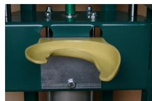
Если требуется произвести сжатие пружины, то в связи с вышеупомянутым порядком работы важно правильно выбрать оснастку. Если пружинная опора монтируется внизу, то при этом необходимо принять меры к тому, чтобы диаметр пружины был больше внутренних губок выбранного держателя.
