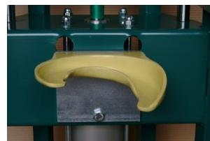
Wenn eine Feder zusammengepresst werden soll, sollte man wegen der oben genannten Sachverhalte sicherstellen, dass man das richtige Zubehör gewählt hat. Wenn man das Federbein unten montiert, muss daher abgesichert sein, dass die Feder einen größeren Durchmesser hat als die inneren Lippen an der gewählten Federhalterung.
