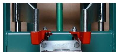
Es kann nötig sein, andere Federhalterungen als die Standardfederhalterungen anzubringen. Dies können entweder Federhalterungen mit kurzen Lippen sein (siehe Foto oben), die vor allem bei den in Japan hergestellten Marken Toyota und Honda verwendet werden. Andere spezielle Federhalterungen sind für verschiedene Automodelle erhältlich.
