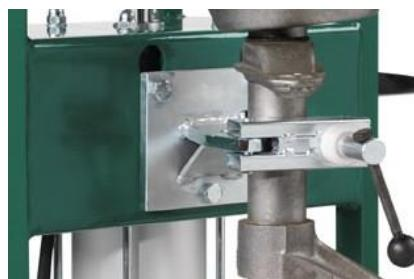
Man säkerställer att läpparna på båda fjäderhållarna är i ingrepp genom att dra ut svängarmarna samtidigt som man gör en mycket långsam nerpressning. **Om fjäderhållarna går att sträcka ut är de inte i ingrepp!!**
