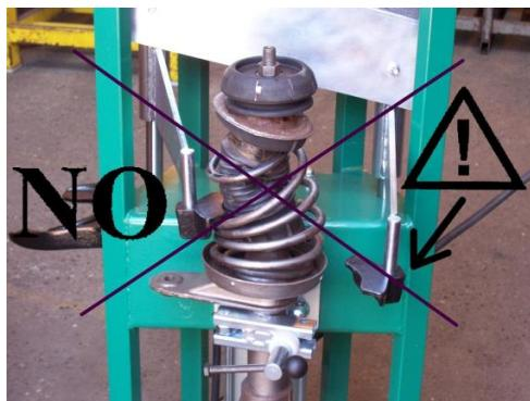
Använd pressen enbart för att pressa fast fjädrar på McPherson-fjäderben! Se alltid till att fjäderhållarna är fästa med alla tre bultarna i de för detta avsedda hålen på ramens framsida.
