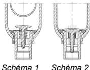
H. Retirer la valve de gonflage monobloc (photo 4) ou la valve intégrée ou l'obus de valve (photo 5) suivant modèles.
